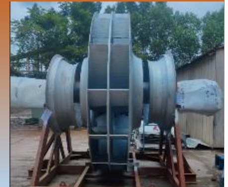
New Preheater Fan
